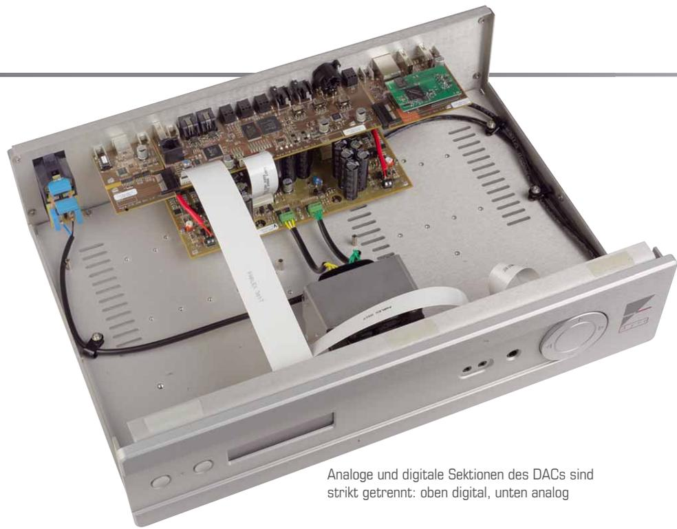
Analoge und digitale Sektionen des DACs sind strikt getrennt: oben digital, unten analog
